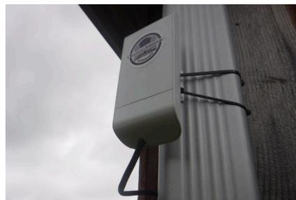
(c) L'antenne utilisée pour la réception est une NanoStation Loco M5, positionnée sur le hangar rouge.
