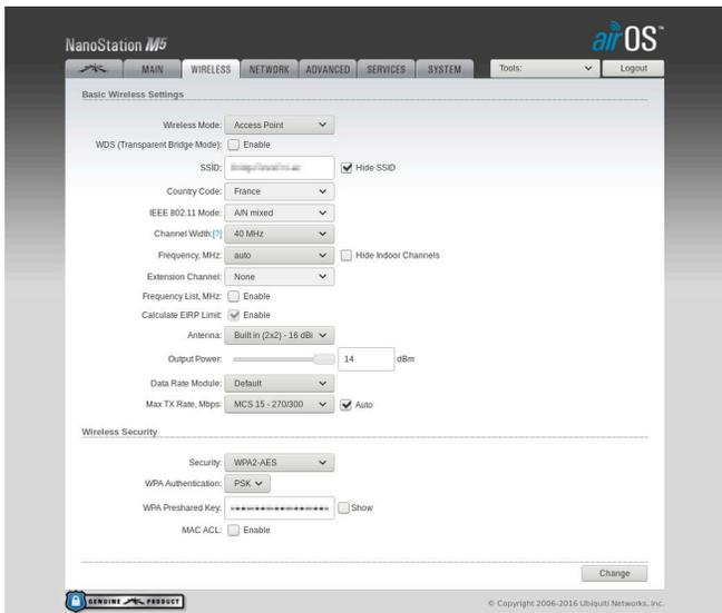
(a) Section Wireless de la NanoStation M5 côté château (Access Point).
