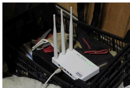
(i) Routeur/borne wifi (configuré en bridge) offert par Tetaneutral.net, permettant de recevoir directement des IP du château. Le réseau wifi porte directement le nom de la compagnie de cirque et permet aux caravanes à proximité de se connecter à Internet.
